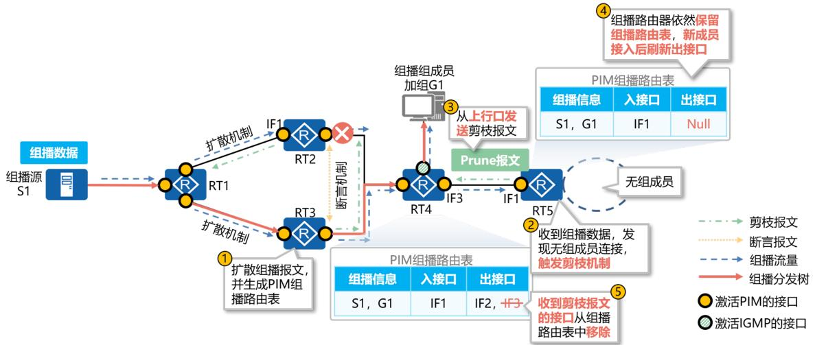
注：路由器为被裁剪的下游接口启动一个剪枝定时器（默认210s），定时器超时后接口恢复转发。组播报文重新在全网范围内扩散，新加入的组成员可以接收到组播报文。随后，下游不存在组成员的叶子路由器将向上发起剪枝操作。通过这种周期性的扩散-剪枝，PIM-DM周期性的刷新SPT。
