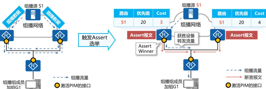
注：Assert选举失败的设备会抑制转发，并将这种抑制转发的状态保持一段时间，这段时间就被称为Assert保持时间，默认180s。Assert保持时间超时后，竞选失败的设备会恢复转发从而触发新一轮竞选
