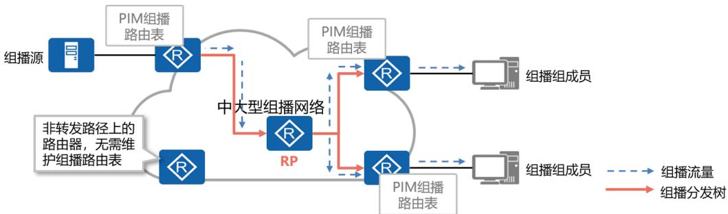
注：通过PIM-SM【ASM】模式形成组播分发树有如下好处：只有组播转发路径上的组播路由器需要维护组播路由表、通过RP可以让所有组播路由器获知组成员的位置、避免“扩散-剪枝”机制，提高组播分发树的形成效率
