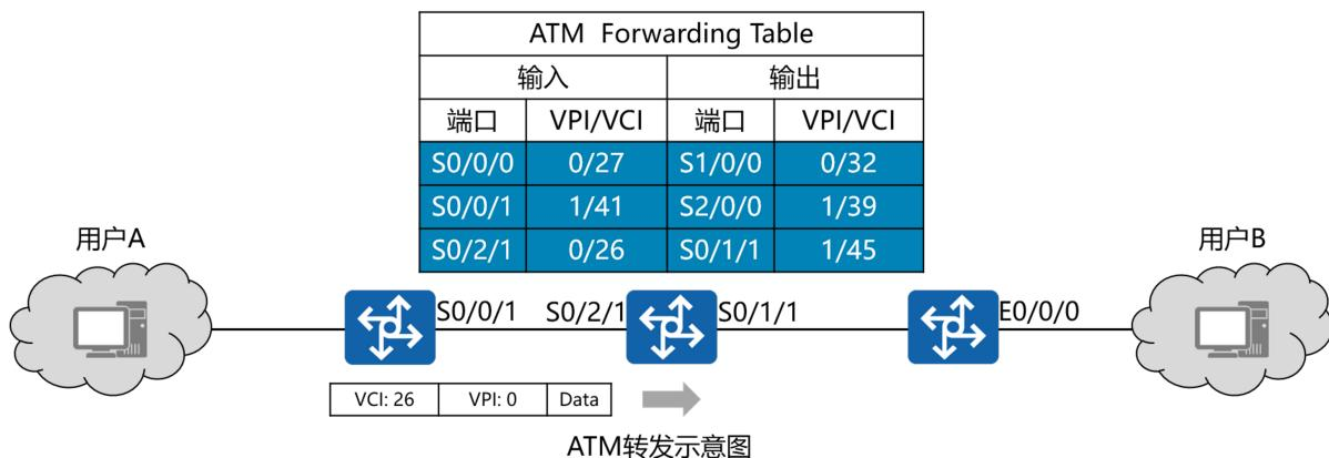
2.1、ATM【Asynchronous Transfer Mode | 异步传输模式】指建立在电路交换与分组交换的基础上的一种交换技术
