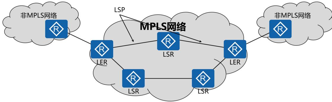
1、MPLS网络由多台支持MPLS技术的路由器组成，这些路由器被称为LSR【标签交换路由器 | Label Switch Router】或者LER【标签边界路由器 | Label Edge Router】
