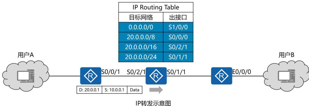
1.1、IP转发采用最长匹配，需多次查表，算法效率低下
