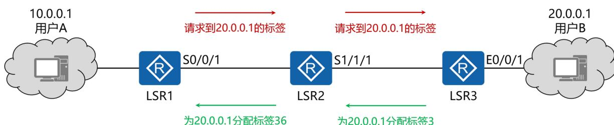
上游LSR先向下游LSR发送标签请求消息【包含FEC的描述信息】
