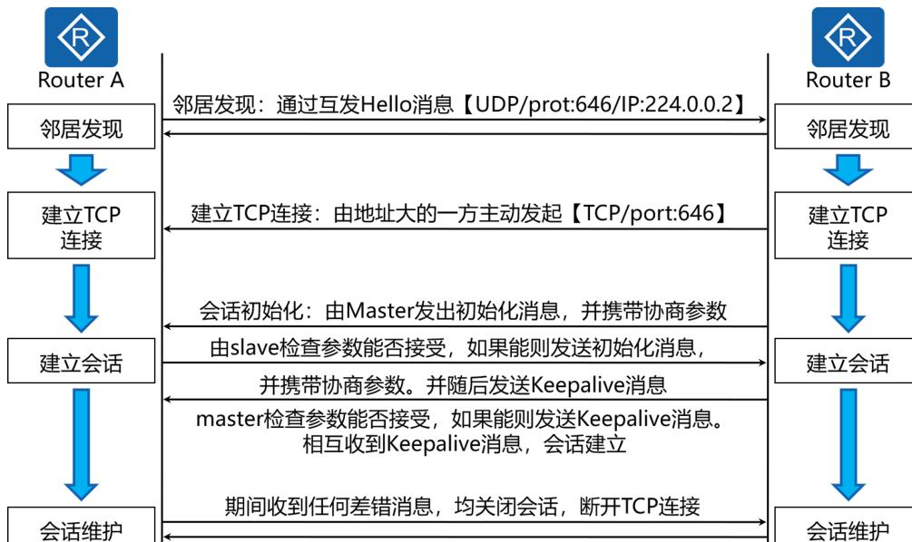
协商参数包含：LDP版本号、Keepalive时间（180s）、标签分配方式、PDU长度：默认为4096Byte
