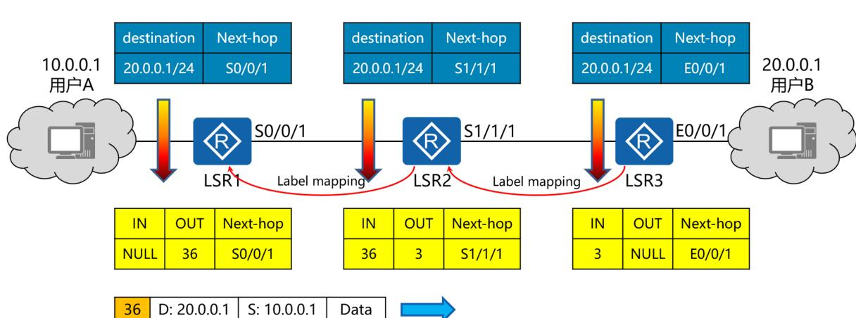
报文进入MPLS网络，LER设备【LSR1】发现报文的目的IP地址有与其关联的标签转发表项，遂进行压标签【PUSH】操作
