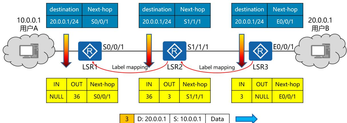
报文在MPLS网络中间进行转发时，在LSR2上进行标签交换【SWAP】，设备只需查询标签转发表即可完成报文转发
