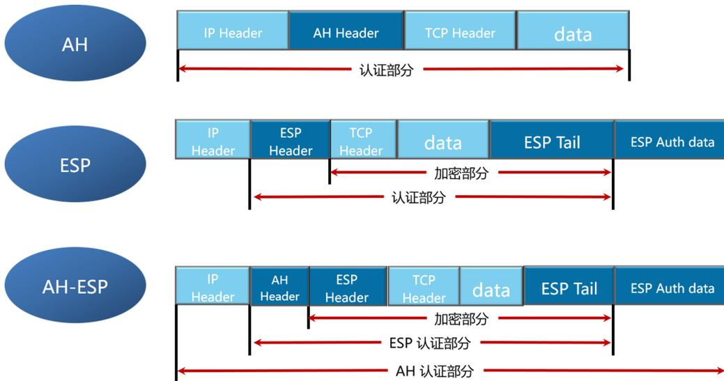
2、隧道模式：IPSec会另外生成一个新的IP报头，并封装在AH或ESP之前；隧道模式中，AH或ESP头封装在原始IP报文头之前，并另外生成一个新的IP头封装到AH或ESP之前。隧道模式可以完全地对原始IP数据报进行认证和加密，而且，可以使用IPSec对等体的IP地址来隐藏客户机的IP地址
