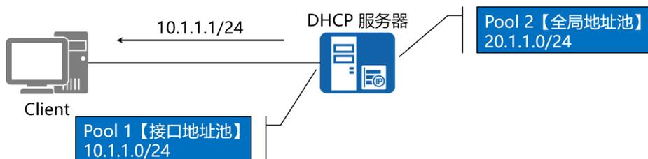
7、DHCP中继代理可以实现在不同子网和物理网段之间处理和转发DHCP信息的功能；若DHCP客户端与DHCP服务器在同一个物理网段，则客户端可正确地获得动态分配的IP地址；若客户端与服务器不在同一个物理网段，则需要DHCP Relay【中继代理】
