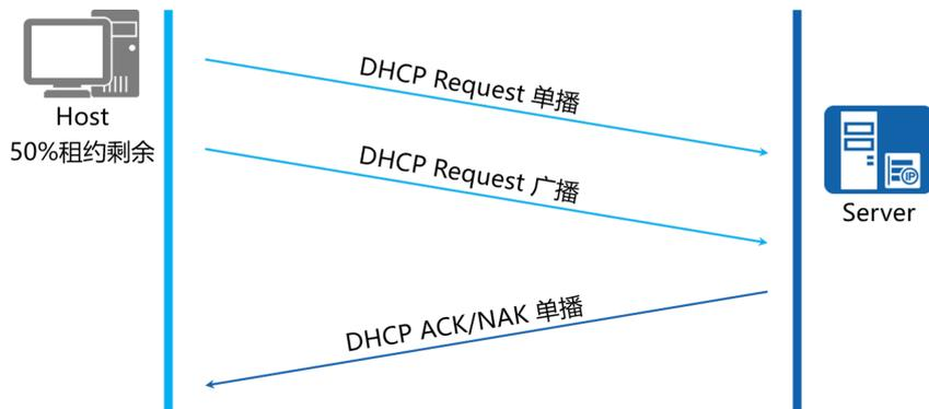
注：DHCP客户端发送DHCP请求报文续租时，若DHCP客户端没有收到DHCP服务器的DHCP应答报文。默认情况下，重绑定定时器在租期剩余12.5%的时候超时，超时后，DHCP客户端会认为原DHCP服务器不可用，开始重新发送DHCP请求报文。网络上任何一台DHCP服务器都可以应答DHCP确认或DHCP非确认报文
