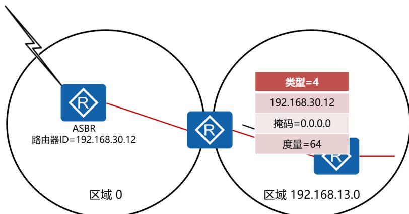
5、自治系统外部LSA：由ASBR发出，将外部路由汇总后注入进OSPF网络内部时使用
