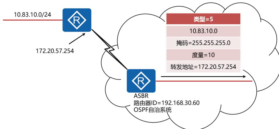
7、NSSA区域LSA：由NSSA区域内部的ASBR发出，将其直连的外部路由转变为类型7的路由注入进OSPF内部时使用
