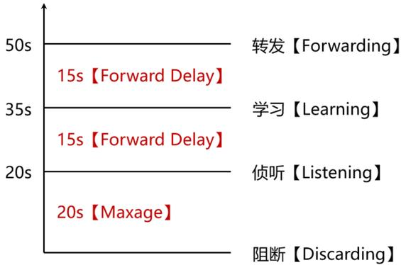
1、交换机对于非直连链路发生的故障需要经过50s的时间恢复【20s + 15s + 15s】
