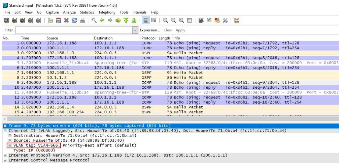
当 STA 设备从 AP-1 漫游至 AP-2 上时，其发送的业务数据的外部二层封装中，VLAN 依旧为 666，但 SWB 与 AC-2 上并没有配置 VLAN 666，因此无法识别 VLAN 666 封装的数据，最终导致网络无法正常通讯
