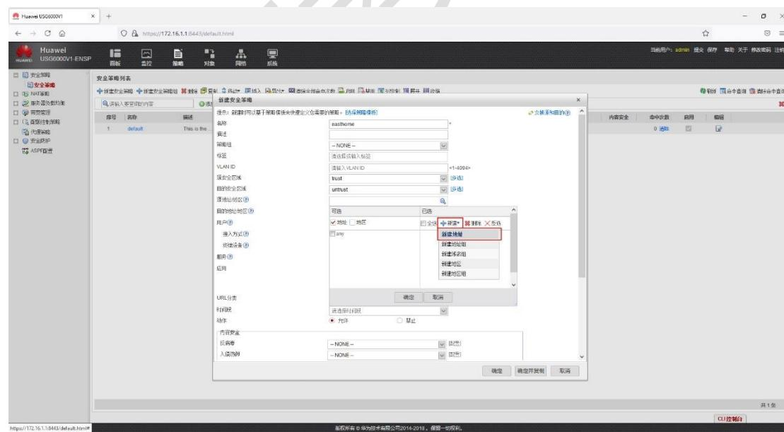
填写名称及内部主机 Client A 的 IP 地址与子网掩码，之后单击【确定】
