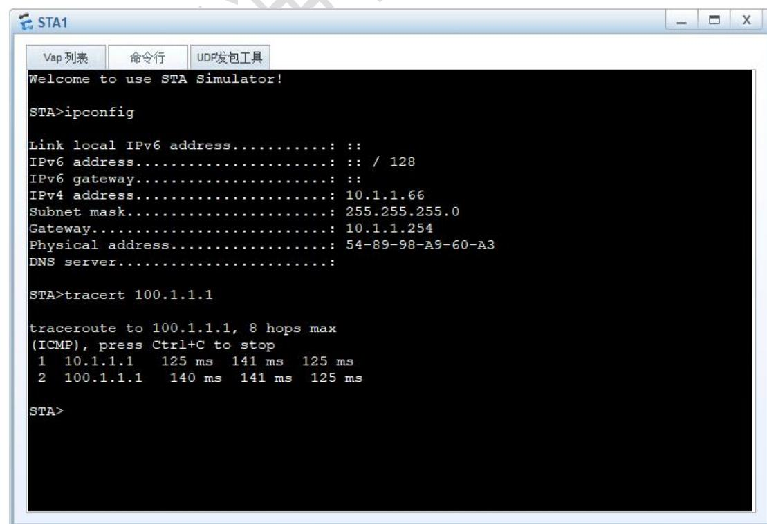
在 AC-1 设备失效时（此处将 AC-1 的 G0/0/2 端口手工 down 掉，模拟上行链路失效），再次检测 STA 设备所获取的 IP 地址，同时测试与目标网络的连通性，并再次观察所经过的路径：
