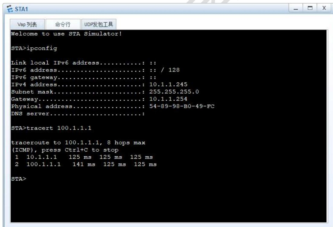
在 AC-1 设备失效时 (此处将 AC-1 设备关机, 模拟设备失效), 观察 AC-2 需要多久才能够从 stdby 状态变为 nor 状态(25s x 3):
