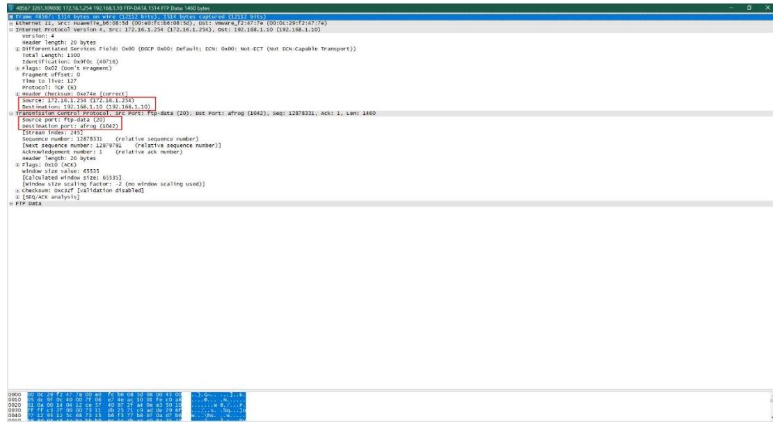
通过获取的数据包发现，此时 FTP Server 向 Client A 传输的数据，使用的源端口号为 20 号 (ftp-data)
