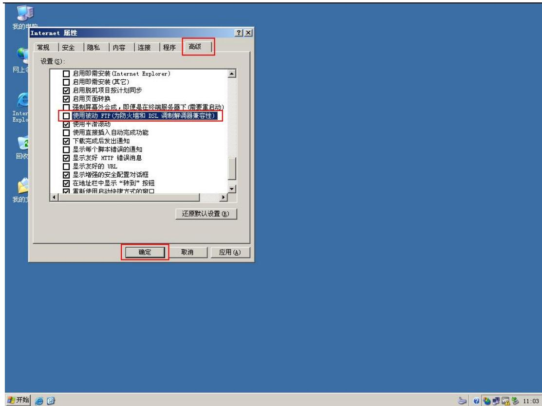
在打开的属性页面中，选择“高级”选项页，取消掉“使用被动FTP（为防火墙和DSL调制解调器兼容性）”选项，并单击确定，之后需重启系统；在Client A上，亦需要同样的操作，此处不再截图赘述
