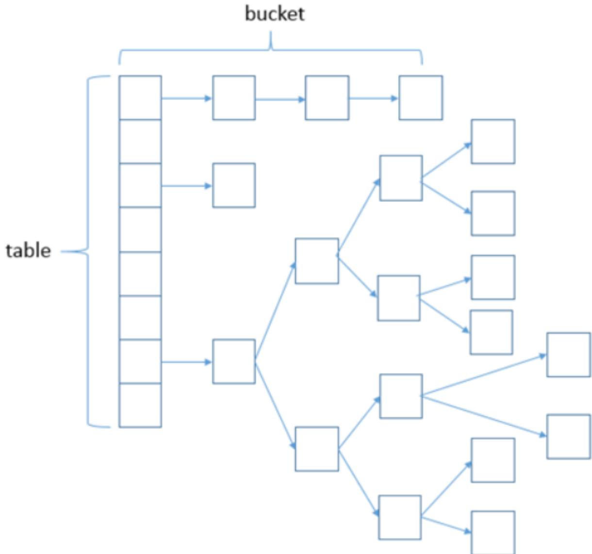
在 JDK1.7 及之前的版本中, HashMap 又叫散列链表: 基于一个数组以及多个链表的实现, hash 值冲突的时候, 就将对应节点以链表的形式存储。
